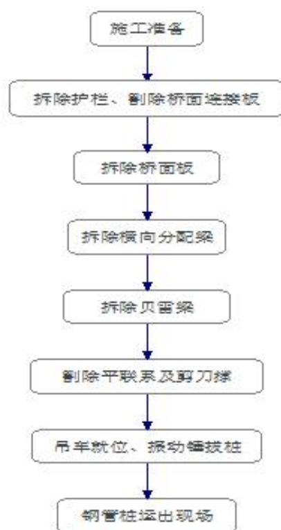
图 2.3-7 施工钢便桥拆除流程图
